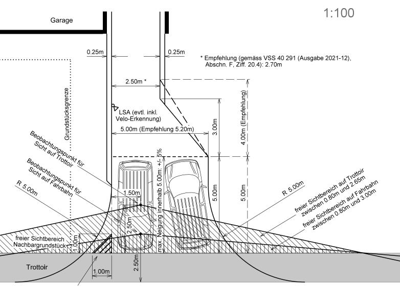
1x1m-Regel: absolutes Minimum der notwendigen Sicht aufs Trottoir (wenn die Gewährleistung einer grösseren Sichtweite unverhältnismässig wäre); freier Sichtbereich zwischen 0.80m und 2.65m
