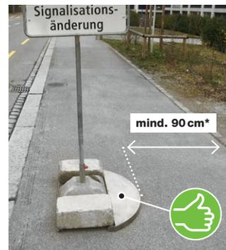
Signaltafeln sind dank einfacher Montage des Schutzelements beim Schienensockel fussgängerseitig taktil erfassbar. Auch Selbstabholern/Mieter stehen die Schutzelemente zur Verfügung.
