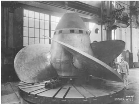
Titel: Karusselldrehbank „Schiess“ mit Laufrad für Schreckenstein Jahr: 1935 Signatur: VII.419.:34.1.1.2.1.05.01.
