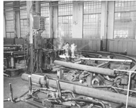
Titel: Rohrschlosserei, Rohrbiege- einrichtung Jahr: 1957 Signatur: VII.419.:34.1.1.3.7.17.02.
