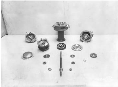
Titel: Detail zur Oelpumpe von Dampfturbine Nikonpulp Jahr: 1938 Signatur: VII.419.:34.1.1.6.1.34.02.
