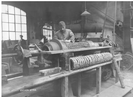
Titel: Teilansicht der Kernmacherei mit Kern auf Drehbank Jahr: 1938 Signatur: VII.419.:34.1.1.7.1.19.02.
