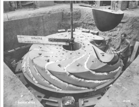
Titel: Einbau der Kerne eines Francisturbinenrades in der Gussformerei Jahr: 1938 Signatur: VII.419.:34.1.1.7.3.10.02.
