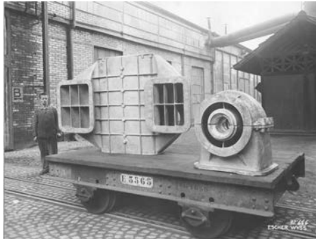
Titel: Transport von Gehäuse für Axialgebläse Gebrüder Sulzer Jahr: 1939 Signatur: VII.419.:34.1.1.7.3.6.02.
