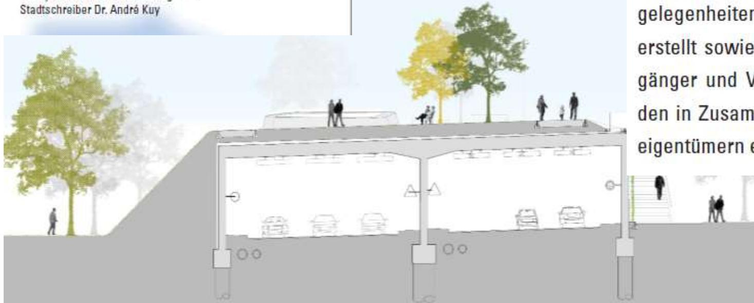
Das Dach der Einhausung wird mit Erdreich überdeckt und als öffentlicher Freiraum nutzbar. Die zur Abstimmung stehende Kreditvorlage sieht eine Basisbegrünung und eine minimale Oberflächengestaltung vor mit Wegen, Beleuchtung, Bepflanzung und Sitzgelegenheiten. Seitlich werden zum Teil Böschungen erstellt sowie Rampen für Fussgängerinnen und Fussgänger und Velofahrende. Spätere Ergänzungen werden in Zusammenarbeit mit den angrenzenden Grundeigentümern entwickelt.
