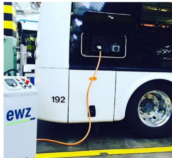
Der Batteriebus wird für den Probetrieb in der Garage aufgeladen.
